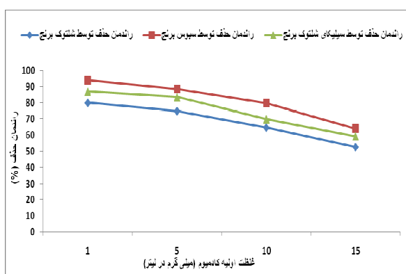
نمودار ۲. نتایج اثر غلظتهای مختلف کادمیوم بر کارایی حذف توسط سه جاذب شلتوک، سیوس و سیلیکای شلتوک برنج با زمان تماس ۶۰ دقیقه، pH برابر ۶ و جرم مواد جاذب ۱ گرم در لیتر
