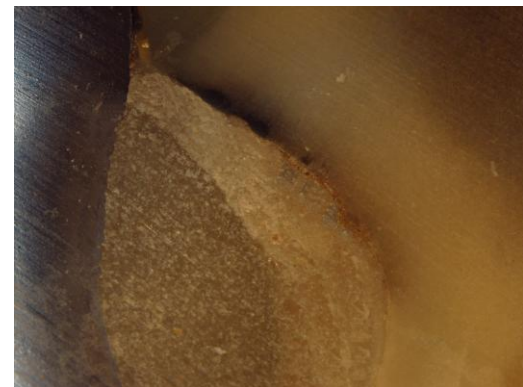
شکل ۳. تصویر استریومیکروسکوپ از لبه مینایی گروه Adper Single Bond 2 با رتبه ریزشست صفر
