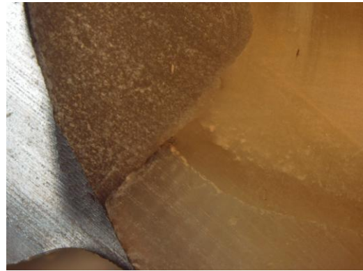
شکل ۲. تصویر استریومیکروسکوپ از لبه مینایی گروه S 3 Clearfil Bond با رتبه ریزشست یک
