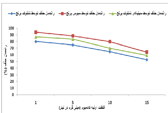
نمودار ۲. نتایج اثر غلظتهای مختلف کادمیوم بر کارایی حذف سه جاذب شلتوک، سیوس و سیلیکای شلتوک برنج با زمان تماس ۶۰ دقیقه، pH برابر ۶ و جرم مواد جاذب ۱ گرم در لیتر
