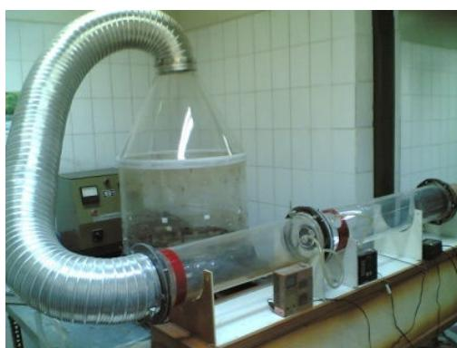
شکل ۱: وان آبکاری، محفظه استوانه ای و مخروطی هدایت کننده میست، لوله هدایت کننده میست به توغل تست و توغل تست
