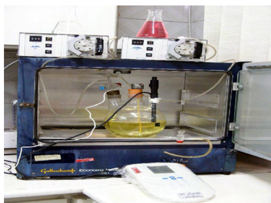
شکل ۱. فرمتور طراحی شده برای انجام آزمایشات بهینه سازی تولید استرپتوکیناز
