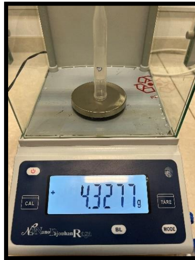
شکل ۱. وزن کردن لوله‌های بدون درب روی ترازوی با دقت 0/0001 گرم
